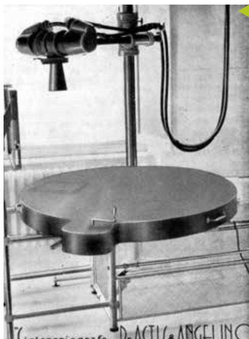
1950 - Seriografo manuale circolare per angiografia per esecuzione di 8 radiogrammi serati in 6-8 secondi, progettato e messo in funzione all'ospedale Koelliker, diretto dal prof. Baudolino Mussa
